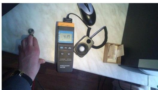
Рисунок 4. Прибор для измерения люксамперной характеристики (люксметр)
