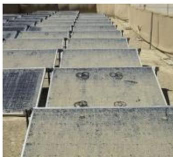
Рисунок 1. Пылеотложения на солнечных элементах
