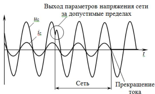
Рис. 3. Иллюстрация срабатывания защиты *Anti-Islanding Protection*
