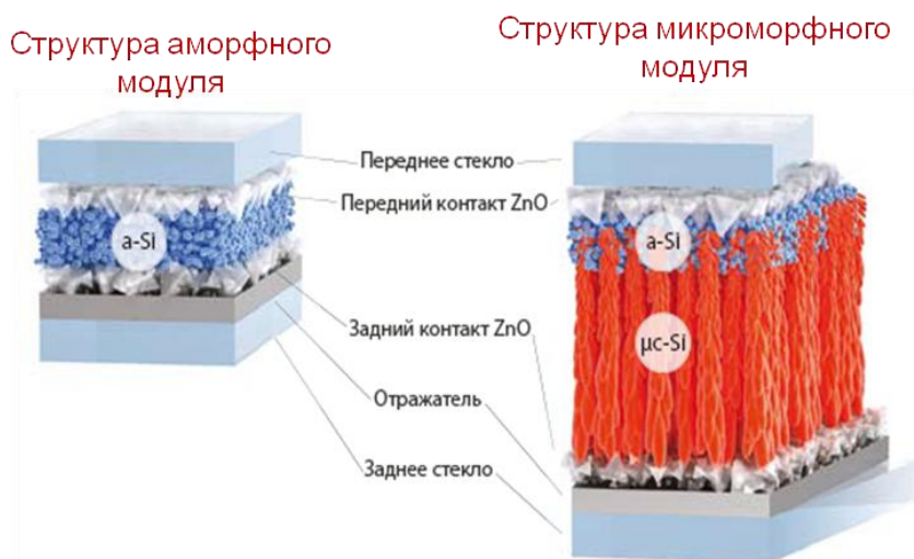
Рисунок 2. Вид солнечного элемента a\text{-Si} и a\text{-Si}+\mu\text{c-Si} [3]
