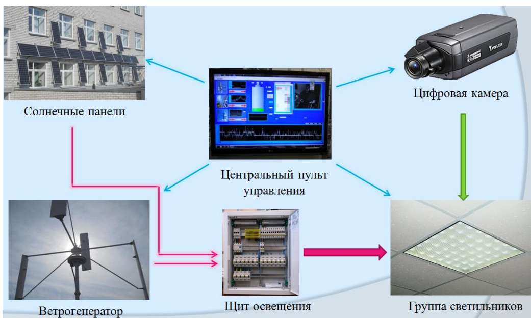
Рис. 2. Структурная схема демонстрационно-лабораторного комплекса интеллектуальных систем искусственного освещения и альтернативной энергетики
