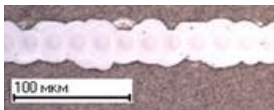
Рис. 2. Микрофотография реза P1. Мощность лазерного пучка выбрана неверно.
